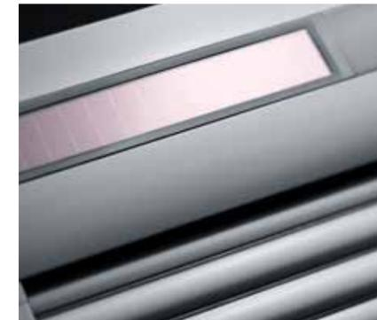
Mittels integrierter Solarzelle wird der Akku aufgeladen und die Funktionalität des solarbetriebenen Rollladens – unabhängig von Tages- und Jahreszeit – sichergestellt.
